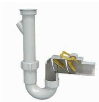
**Abb. 16.7** Mechanischer Rückstauverschluss, integriert in Ablaufgarnitur – nur bei fäkalienfreiem Abwasser zulässig.
