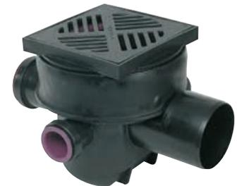
**Abb. 16.6** Bodenablauf mit integriertem mechanischem Rückstauverschluss – nur bei fäkalienfreiem Abwasser zulässig.
