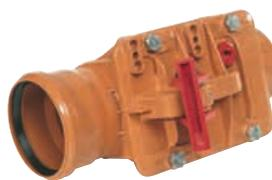
**Abb. 16.5** Mechanischer Rückstauverschluss mit zwei selbsttätigen Verschlüssen – nur bei fäkalienfreiem Abwasser zulässig.
