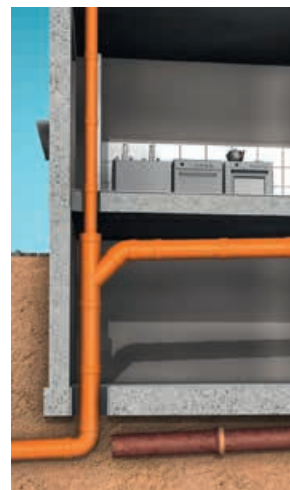
Abhängung unter der Kellerdecke und Stilllegung des alten Kanals
