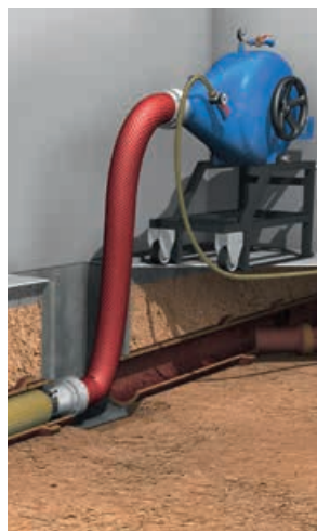
Schlauchliner in geschlossener Bauweise
