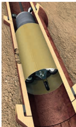
Kurzliner in geschlossener Bauweise
